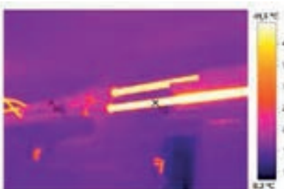
DIAGNOSI ENERGETICA/2. Termografia delle reti di distribuzione del fluido termovettore
